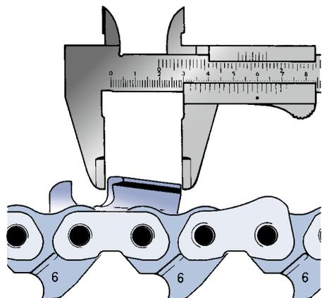
Damit die Schneidezähne untereinander immer die gleiche Länge haben, soll beim Schärfvorgang bei allen Zähnen die gleiche Anzahl von Feilstrichen geführt werden. Bei einer Generalinstandsetzung soll die Zahnlänge mit einer **Schublehre** kontrolliert und auf gleiche Länge gefeilt werden.
